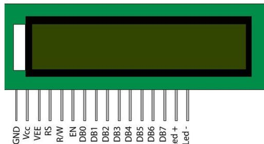
Figura N.º 5. Pantalla LCD 16x2.
